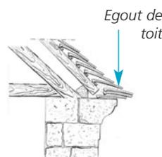
La cassure de pente et le débord de toiture protègent le mur des eaux pluviales. Ce dispositif technique peut être réalisé soit par un travail de maçonnerie : superposition de plusieurs tuiles sur une corniche en débord, soit par un travail de charpente : le coyau.
