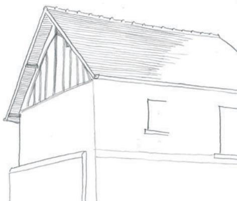
En fonction des techniques constructives : différents traitement des rives du toit
